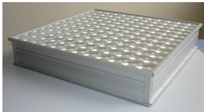
Схема части разработанного концентраторного модуля на основе линз Френеля и каскадных солнечных элементов и фотография созданного модуля
